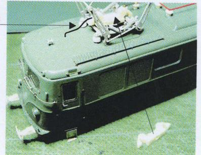
Repercer au diamètre 2 mm la pièce représentant le système de levée de panto de manière qu'elle s'encastre sur l'extrémité de la vis de fixation. Percer également au diamètre 0,5 mm une des faces pour insérer un fil de laiton pour simuler le tuyau d'air comprimé.
