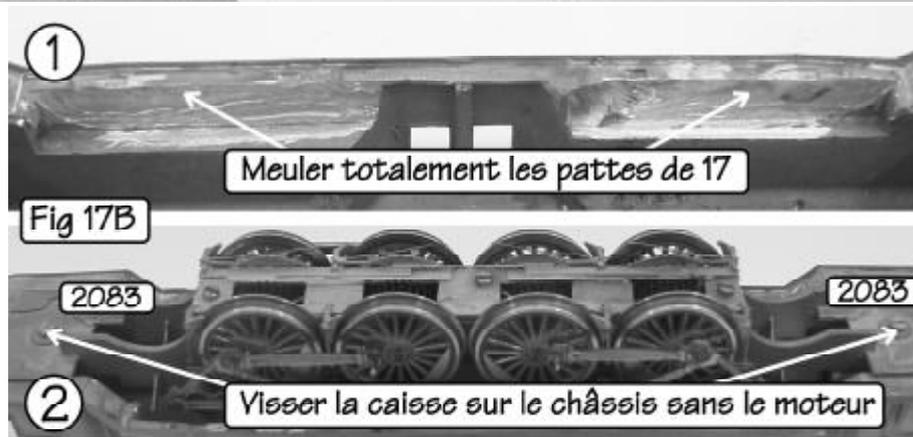
Noter l'endroit du blocage avec un crayon démonter et meuler. L'embellage doit tourner sans accrocher ni effleurer le côté de la caisse. Répéter ces opérations tant que le fonctionnement ne sera pas parfaitement libre.
