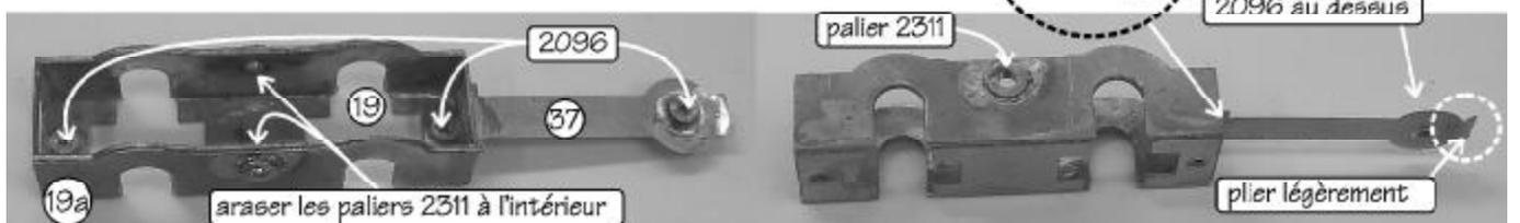
6.3 : Détacher les pièces 19 & 19a. Plier le boggie 19 puis souder 2 écrous 2096 à l'intérieur. Souder les doublages 19a à l'extérieur en veillant à leur alignement. Puis souder 2 palier 2311 par l'extérieur et bien araser l'intérieur.
